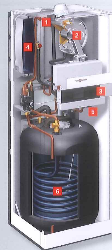
Vitodens 222-F (type B2SB) avec ballon en acier émaillé à serpentin intégré conçu pour les régions où l'eau est dure
